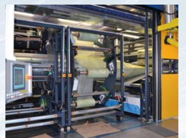
Gigantische Ausmaße: Ein 4 m großer Wickelkörper rotiert um die Zunge und wickelt die vorimprägnierten Glasfaserbahnen um die Schlauchfolie.
