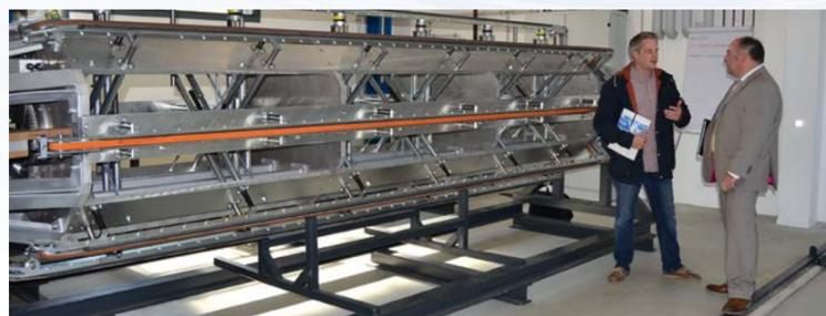
Mannshoch: Die „Zunge“ ist im Durchmesser von 1.200 bis 1.600 mm verstellbar. Dabei sind die Umlenkrollen der Zahnriemenantriebe so angeordnet, dass die Umschlingungslänge für die Zahnriemen konstant bleibt.
