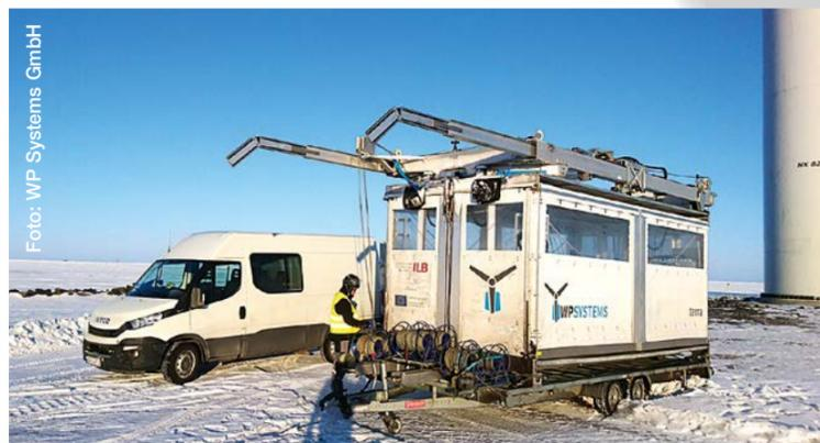
Der Tandem-Achs-Trailer mit der Befahranlage System terra 1.1 von WP Systems in Schweden. Die 3,5 Tonnen zulässige Gesamtgewicht dürfen trotz der vielen Technik wie Steuerung, Stromversorgung, Seilwinden etc. nicht überschritten werden.
