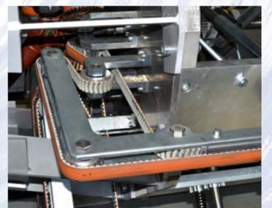
Angepasst: Die widerstandsfähige Linatril-Beschichtung ist entsprechend der Kontur der Umlenkrollen geschliffen.
