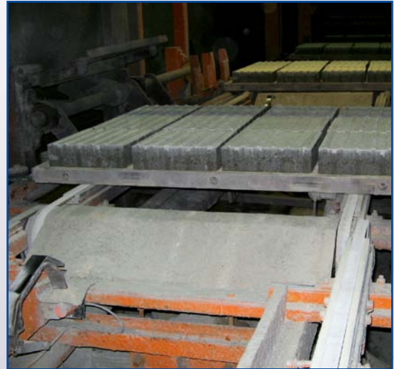
Transportanlage für Betonsteine.
