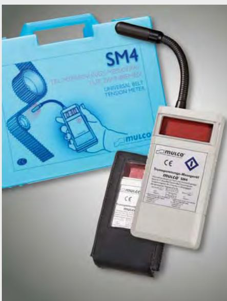
**Das Trumspannungsmessgerät SM4 misst die Frequenz des schwingenden Riemens mit einem Sensor.**
