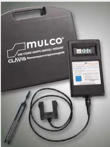
**Das Clavis Messgerät misst die Frequenz des schwingenden Riemens akustisch über Mikrofone.**
