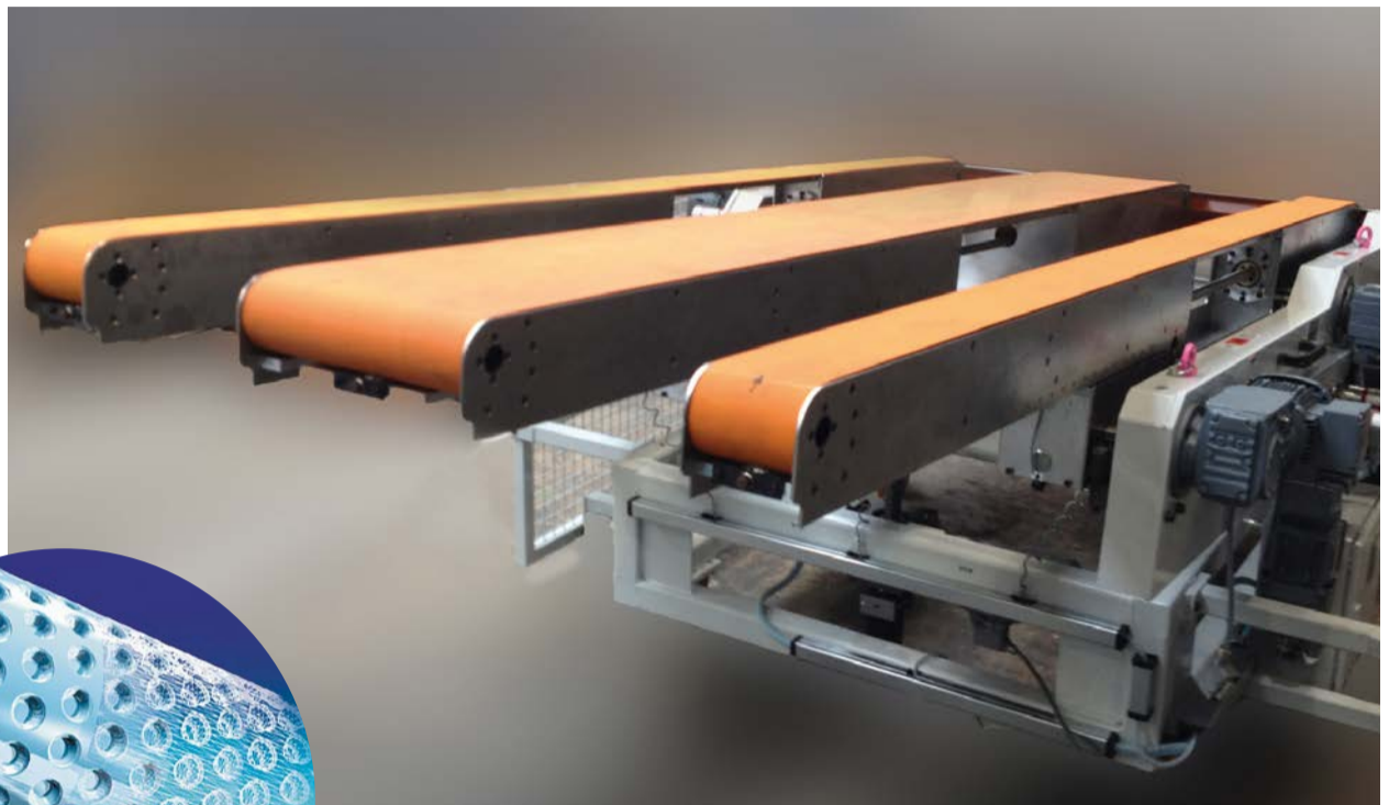
Der weiter entwickelte Teleskoptisch von GPA-Jakob ist in nahezu jede Richtung verfahrbar: in der Neigung, Länge der einzelnen Transporteinheiten und Breite. In der Mitte befindet sich ein 390 mm breiter CONTI® SYNCHRODRIVE N10 Noppenriemen. Flexibler geht es kaum. Bild: GPA-Jakob
