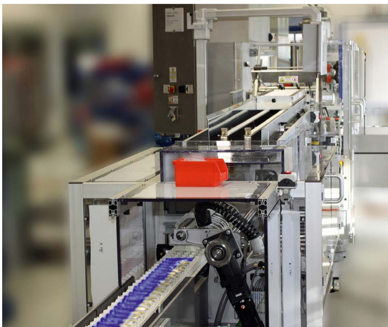
Das Zuführband des OYSTAR Hochleistungskartonierers SC 3 transportiert die Zahnpastatuben. Die Aufnahmeschalen sind auf zwei parallel laufenden BRECO® ATN-Zahnriemen befestigt. Bild: Mulco
