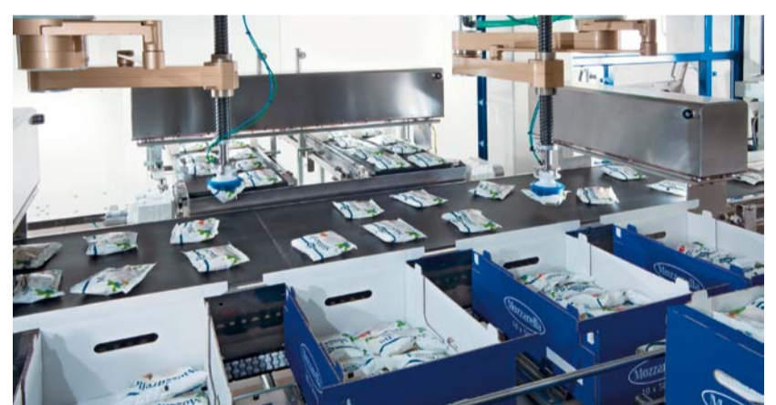
Verpacken von Mozzarella in Einzelbeuteln in den Umkarton. Rechts und links je ein TLM-F4 Roboter
