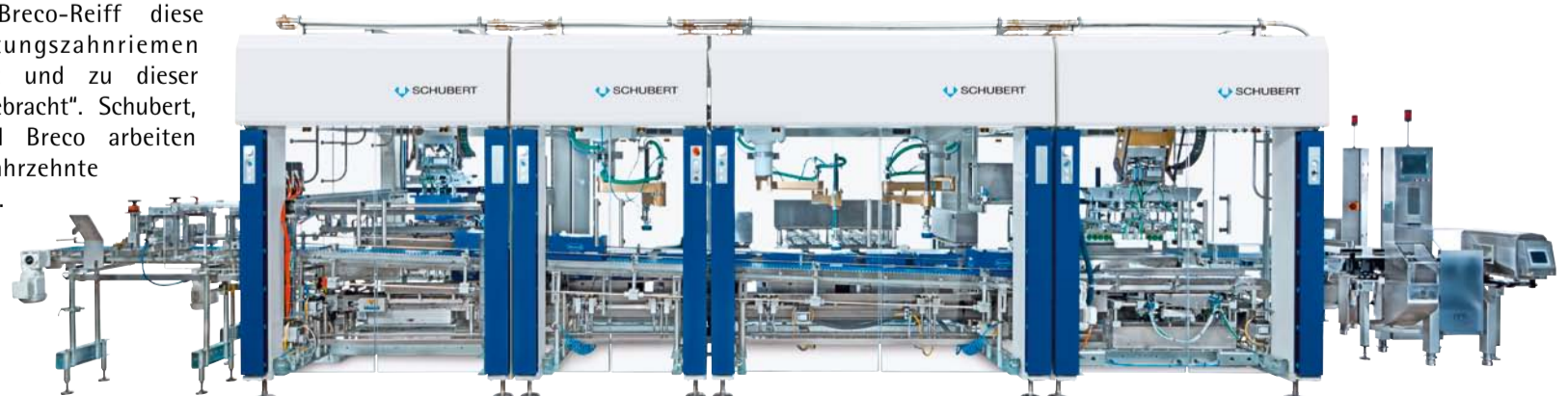
Eine TLM-Verpackungslinie mit drei TLM-F4 Robotern. Hier werden 180 Mozzarella-Beutel pro Minute in 2 Sorten (Mozzarella und Mozzarella Light) verpackt: Ein 10er-Karton mit separatem Deckel, ein 20er-Karton mit Hosenträgerverschluss und ein 40er-Karton mit Hosenträgerverschluss und geschuppt eingelegeten Beuteln.
