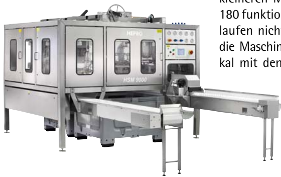
HSM-9000. Die neueste Entwicklung bei den Industrie-Spargelschälmaschinen von HEPRO. Bis zu 10.000 Stangen pro Stunde schafft das System bei minimalster Bruchquote des empfindlichen Gemüses.
