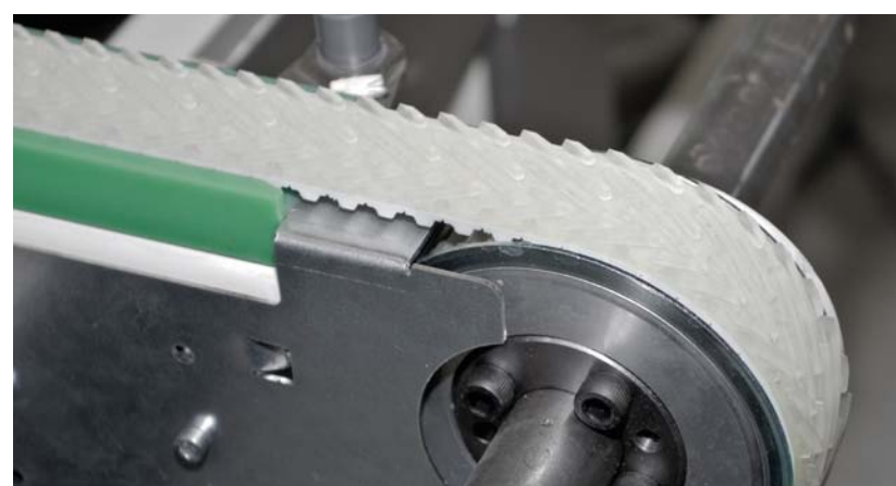
Auch im Einsatz bei Yachtglass zum Transport von Glas: ein 3050 mm langer Polyurethan-Zahnriemen BRECO® 32 T10 mit Fischgrätbeschichtung. Das Glas saugt sich förmlich an den Riemen fest.
