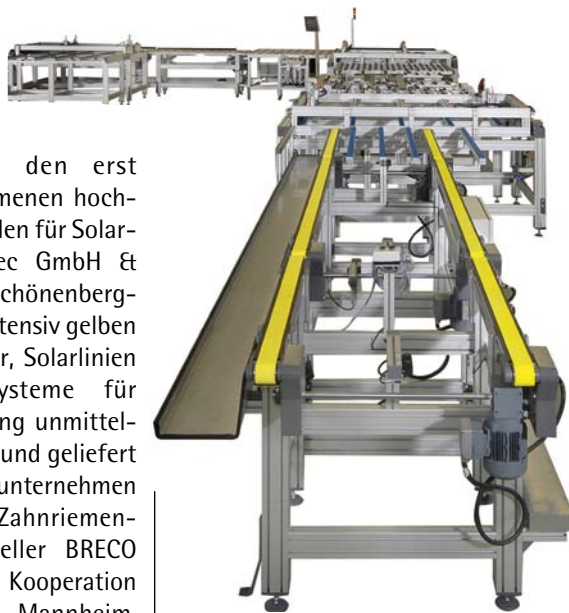
Systeme für die wirtschaftliche Montage von Photovoltaikmodulen sind sehr komplex. Diese Solarlinie ist Bestandteil einer Back-End-Linie, wie sie von MiniTec entwickelt wurde (MiniTec-Werksfoto).
