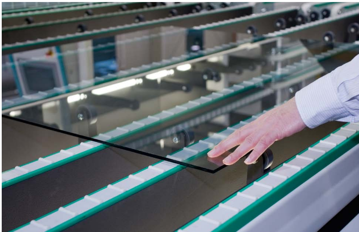
Die großformatige Glasplatte auf dem Prüftisch wird von unten beleuchtet. Gut zu sehen die Transportlösung mit BRECO® 32 T10 Polyurethan-Zahnriemen.
