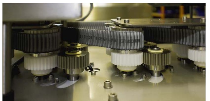
Blick in die Steuerung einer HSM-180: Ein BRECOFLEX® 25 AT 5 von über 5000 mm Länge treibt die schwenkbaren Transportrollen an. Die dunkle Farbe des Polyurethan-Zahnriemens stammt von einer leichten Fettung, die HEPRO für leichten und leisen Lauf in der Montage aufbringt.
