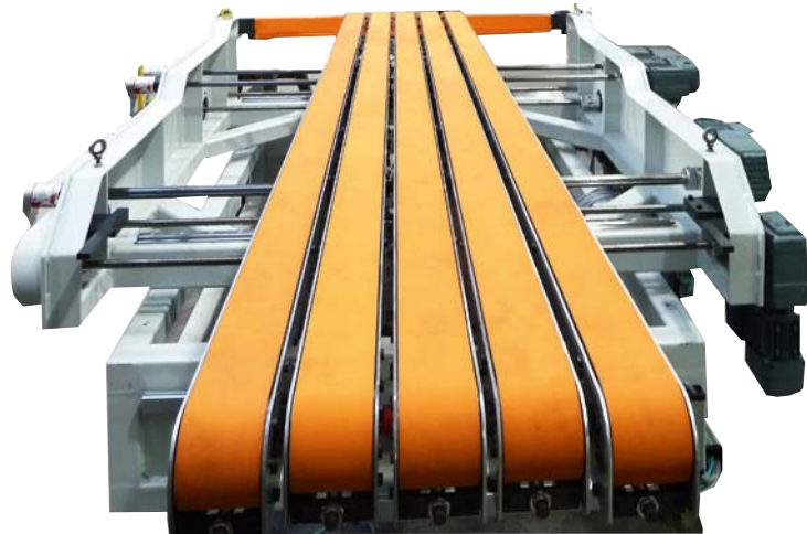
Parallel angeordnete Transporteinheiten mit linatriliumbeschichteten CONTI SYNCHRODRIVE® N10 Noppenriemen. Gut sichtbar auch die Achsen, auf denen in der Breite variiert werden kann. Deren Antrieb erfolgt übrigens über 32 mm breite Hochleistungs-Zahnriemen CONTI SYNCHROFLEX® AT 10.
