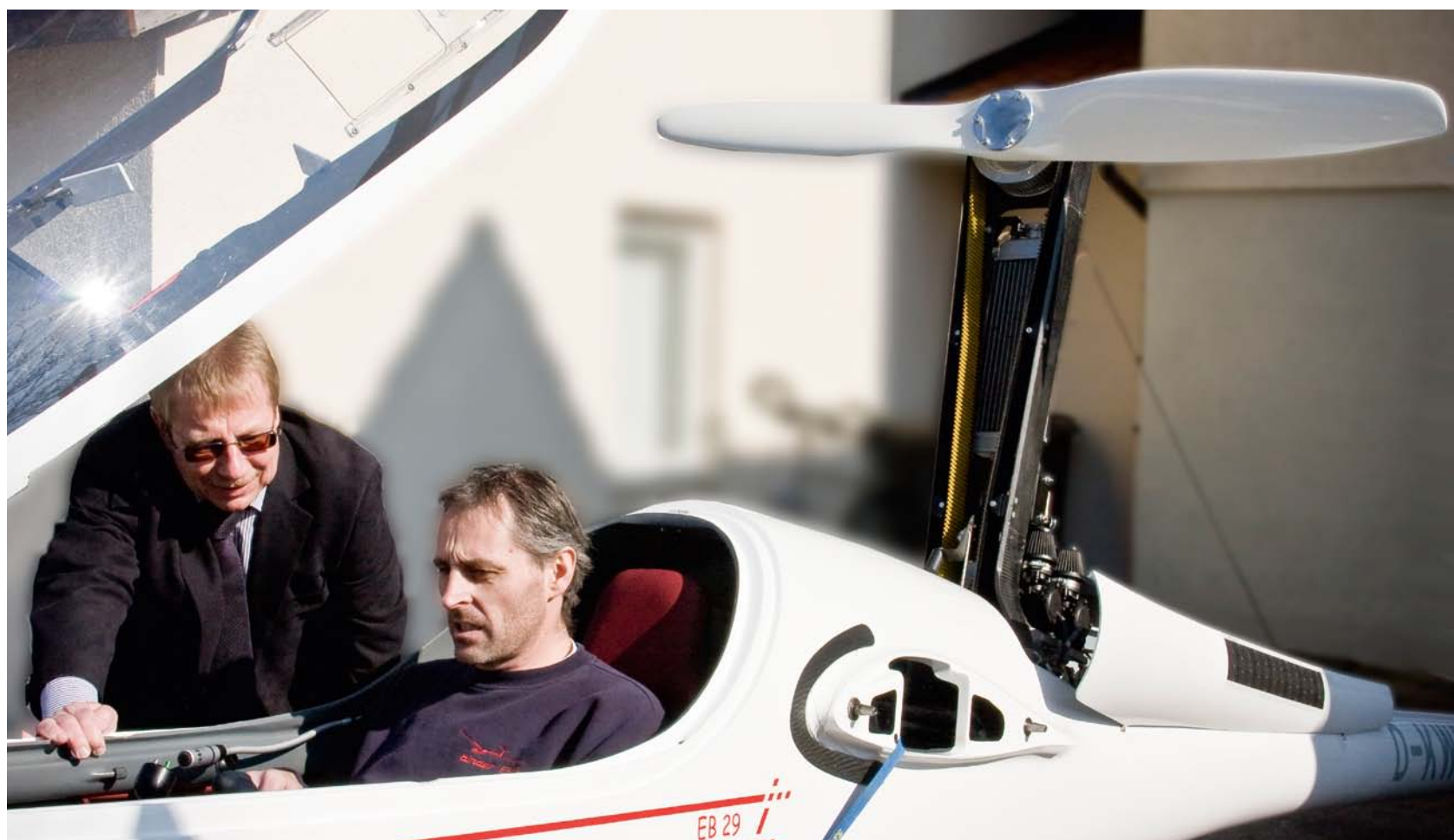
Im Cockpit der Weltmeistermaschine EB 29: Oliver Binder. Er erklärt Reinhold Michl von Mulco-Partner Roth Ingenieurtechnik, Nürnberg/München, wie die gesamte Motoreinheit ein- und ausgefahren wird.
