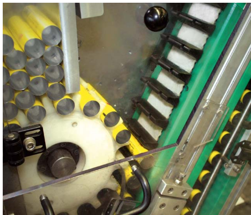
Separierung aus dem 560 Hülsen fassenden Magazin und Ablage auf dem BRECO® ATN-Zahnriemen mit aufgeschraubten Nocken. Deutlich zu sehen auch die Stützschielen, die ein Auslenken des Zahnriemens verhindern.
