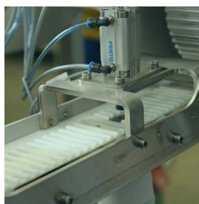
„Tulpen“ (links) mit per Druckluft beaufschlagbaren Silikonmembranen umfassen den Kopf einer Spargelstange und sorgen für sicheren und schonenden Halt während des Transportes und des Schneidvorganges. Rechts ein Blick auf den BRECOFLEX®-Polyurethan-Zahnriemen mit Lochung in der zugstrangfreien Zone.
