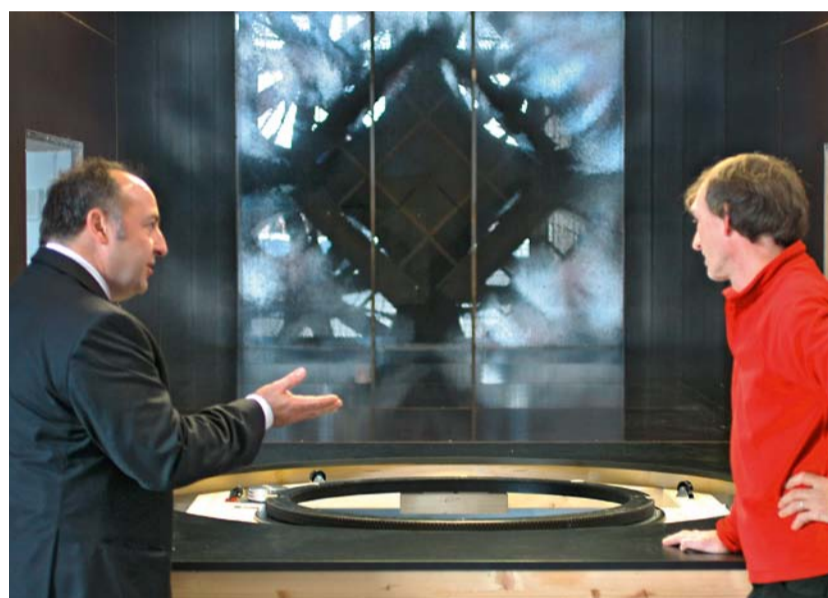
Blick in den Grenzschichtwindkanal mit der geöffneten Modellaufbaufläche. Der Querschnitt beträgt 2,05 x 1,85 m, entspricht in der Charakteristik einem offenen, ländlichen Gebiet und ermöglicht Geschwindigkeiten bis zu 20 m/sec
