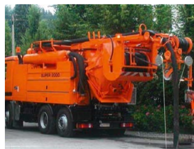
Kanalreinigung System SUPER 2000 im Einsatz
