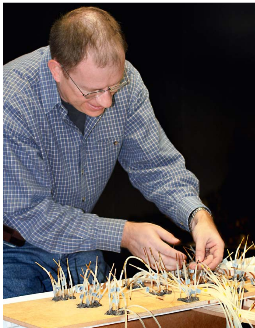
Wacker-Mitarbeiter Arne Blitzer bei der Vorbereitung einer Versuchsreihe im Windkanal. Hier bündelt er das System von Röhrchen und Schläuchen an den Messpunkten
