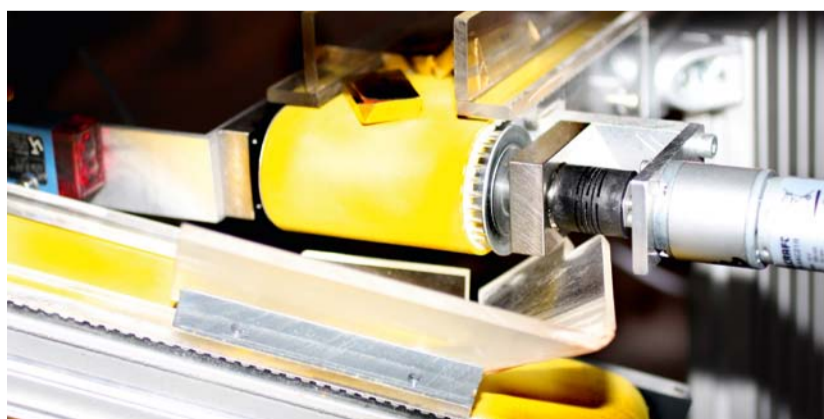
BRECO® AT5-Zahnriemen im Einsatz. Die Schokoladentäfelchen aus dem unterirdischen Depot liegen separiert auf dem per Lichtschranke gesteuerten Separierungsband und fallen einzeln bei Abruf per Taste auf das Transportband zur Ausgabeschale
