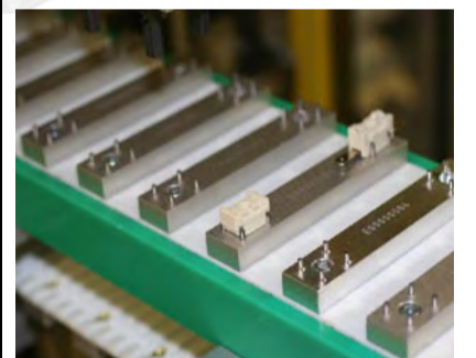
Die konstruktiv sehr saubere Lösung der Werkstückaufnahmen im Detail
