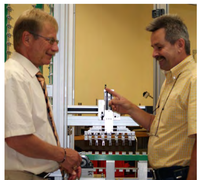
Schrittmotoren treiben teilespezifisch das BRECO® ATN-Taktband mit bis zu 20 mm/sec. an. Konstruktiv überzeugend: verschraubbare Werkstückträger auf dem Zahnriemen
