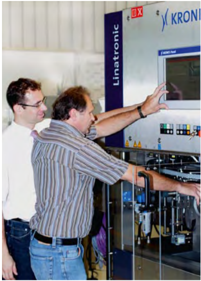
Am übersichtlichen Panel einer Linatronic: Leiter Produktionsteam Jürgen Bruckbauer (links) und Inbetriebnahmetechniker Alfons Bruckmueller. Hinter der Acrylabdeckung gut zu sehen: Durchlaufstation mit Linatronic-Riemen
