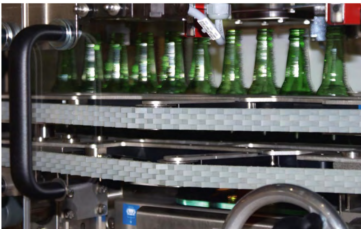
Linatronic-Riemen im Einsatz
