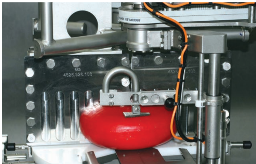
Teilung des Edamerlaibs in zwei Hälften. Gut über dem Messer zu sehen ist der Polyurethan-Zahnriemen BRECOFLEX® 12AT/5 x 990. Er treibt den Schwenkarm an, der die Hälften zur Schneidstation weiter transportiert.
