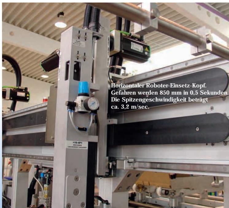
Horizontaler Roboter-Einsatz-Kopf. Gefahren werden 850 mm in 0,5 Sekunden. Die Spitzengeschwindigkeit beträgt ca. 3,2 m/sec.
