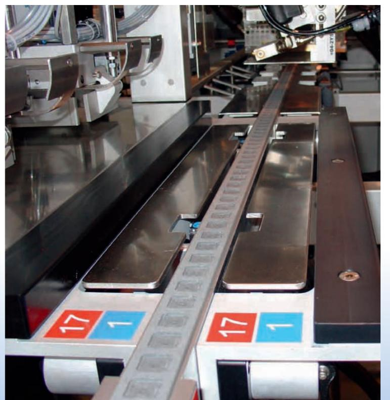
Vakuumband, gefahren werden 850 mm in 1,2 sec, erreicht wird eine Spitzengeschwindigkeit von ca. 1,5 m/sec.
