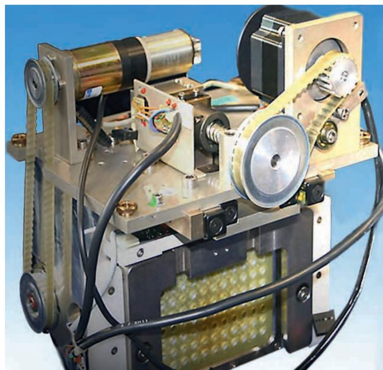
Antriebseinheit des CyBi®-Well vario mit SYNCHROFLEX® Polyurethan-Zahnriemen und RoHS-konformen Synchronscheiben und Spannrollen von Mulco.
