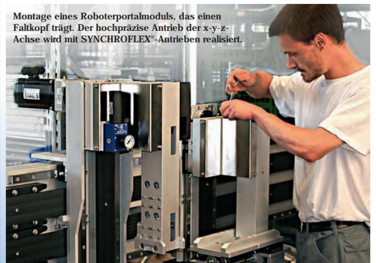
Montage eines Roboterportalmoduls, das einen Faltkopf trägt. Der hochpräzise Antrieb der x-y-z-Achse wird mit SYNCHROFLEX®-Antrieben realisiert.
