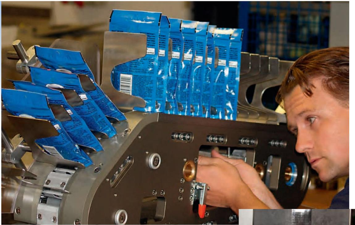
Der Transport von Desserttüten im Wrap Around Packer erfolgt mit Hilfe eines SYNCHROFLEX® 75 AT10.
