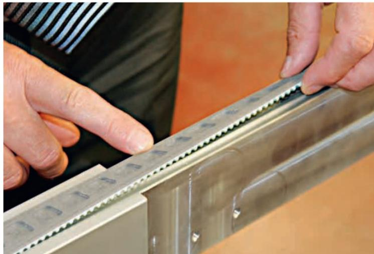
Als Förderriemen kommt ein endlos verschweißter Vakuumpolyurethan-Zahnriemen der Marke BRECO® (Breite 25 mm, Länge 3600 mm) zum Einsatz.
