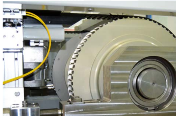
Knapp einen halben Meter Durchmesser haben die Riemenscheiben. Bordscheiben sind nur auf einer Seite angeordnet, da die Querträger die Riemen axial miteinander verbinden.
