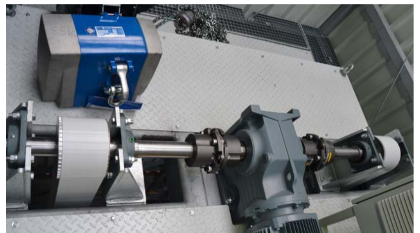
Ganz oben: Der Servoantriebsmotor verteilt sein Drehmoment über Stahllamellenkupplungen an die Zahnriemenscheiben. Die Zahnscheiben mit 230 mm Durchmesser sind beidseitig in massiven Gehäuselagern gelagert.
