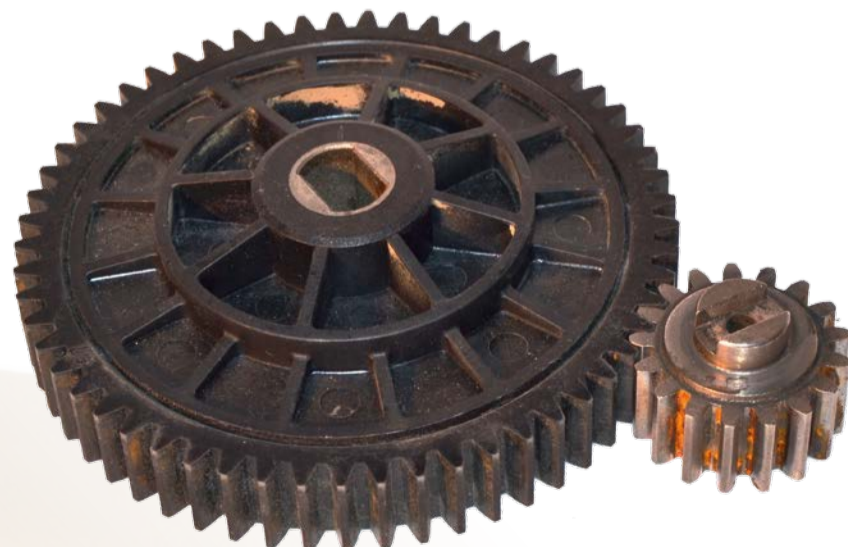
Verschleißanfälligkeit und unangenehme Geräusentwicklung: der serienmäßig eingesetzte Stirnradsatz.
