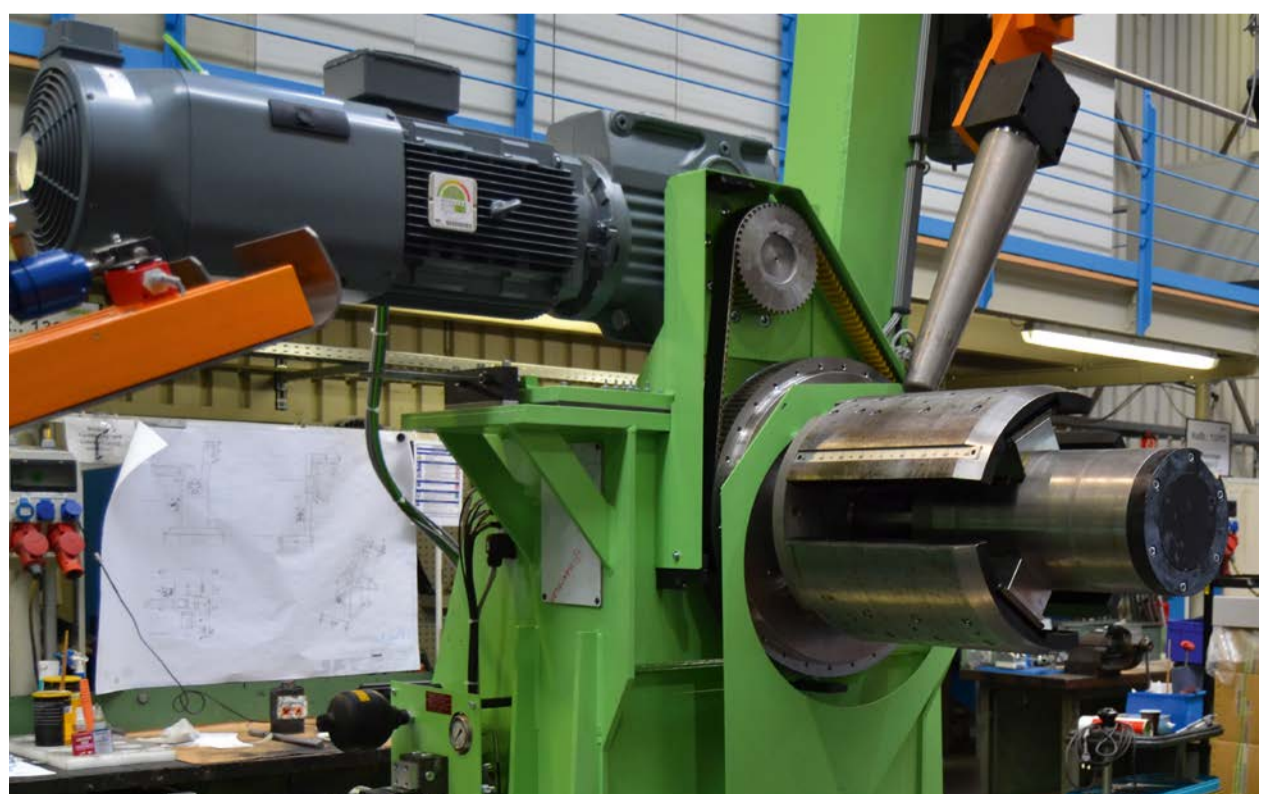
Die komplette Haspel mit angeflanschem Kegelradgetriebemotor und abgenommener Zahnriemenabdeckung
