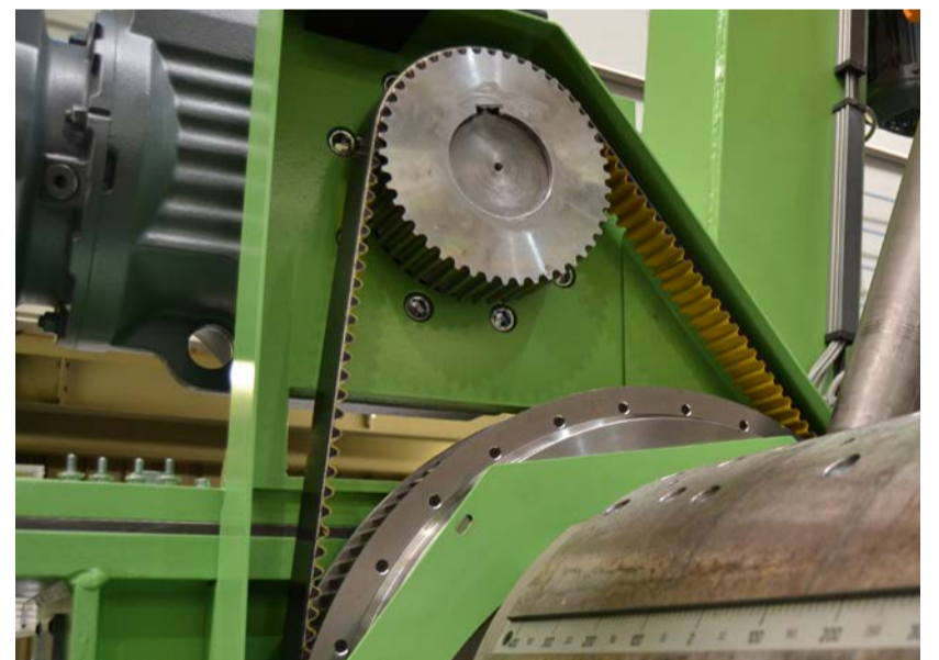
Wartungsfrei und über viele Jahre hinweg wird der Hochleistungszahnriemen CONTI® SYNCHROCHAIN seinen Dienst in den Haspeln von Kohler verrichten
