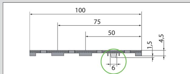
Die Ausformungen für die Einlege-teile sind fertigungs-seitig mit einer ca. 0,2 mm dicken TPU-Haut verschlossen. Zum Einsetzen der Profilbefestigung müssen diese Ausformungen geöffnet werden. Möchten Sie den Zahnriemen gelocht geliefert bekommen, dann teilen Sie bitte Ihrem zuständigen BRECO-Vertriebspartner bei der Bestellung den gewünschten Abstand C mit. Der kleinste Längsabstand der Ausformungen im Riemenzahn entspricht der Teilung des Riemens.
